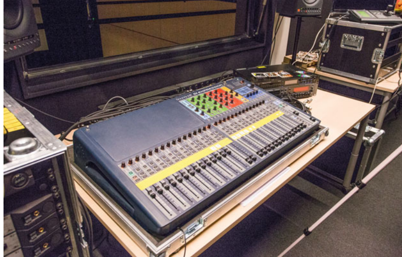
Obie reżyserki Sali Kameralnej – dwie, gdyż salę tę można podzielić na dwie części – wyposażone zostały w konsole Soundcraft Si Expression 3.
